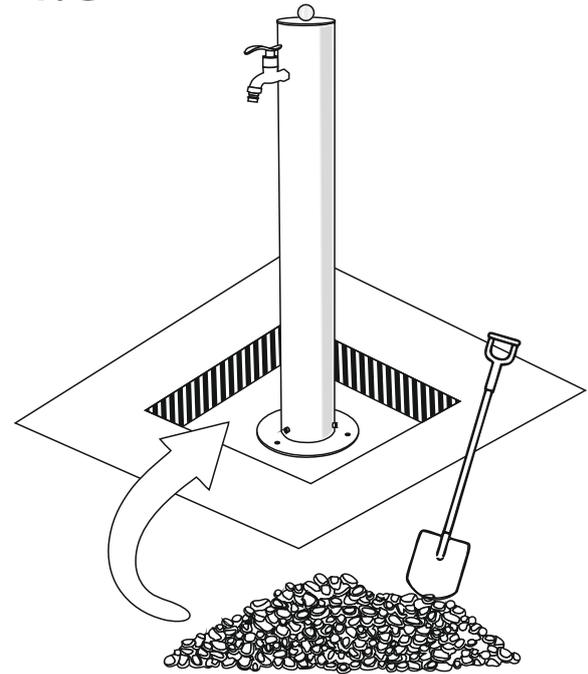
Pri uložení do štrku postačuje umiestnenie kotviacej platne pod úroveň terénu a prihrnutie dostatočnou vrstvou štrku.
