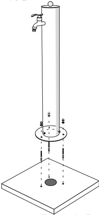
Kotvy osadíte niekoľkými údermi kladivom. Kotviacu platňu upevníte pomocou dodávaných podložiek a klobúkových matíc.
