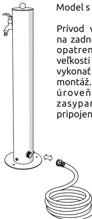
Prívod vody pripojte ku vývodu na zadnej strane stĺpika, ktorý je opatrený vonkajším závitom o veľkosti 3/4". Tento krok je možné vykonať aj po ukotvení čo uľahčí montáž. Pri osadení stĺpika pod úroveň terénu a následnom zasypaní je potreba vykonať pripojenie ako prvé.
