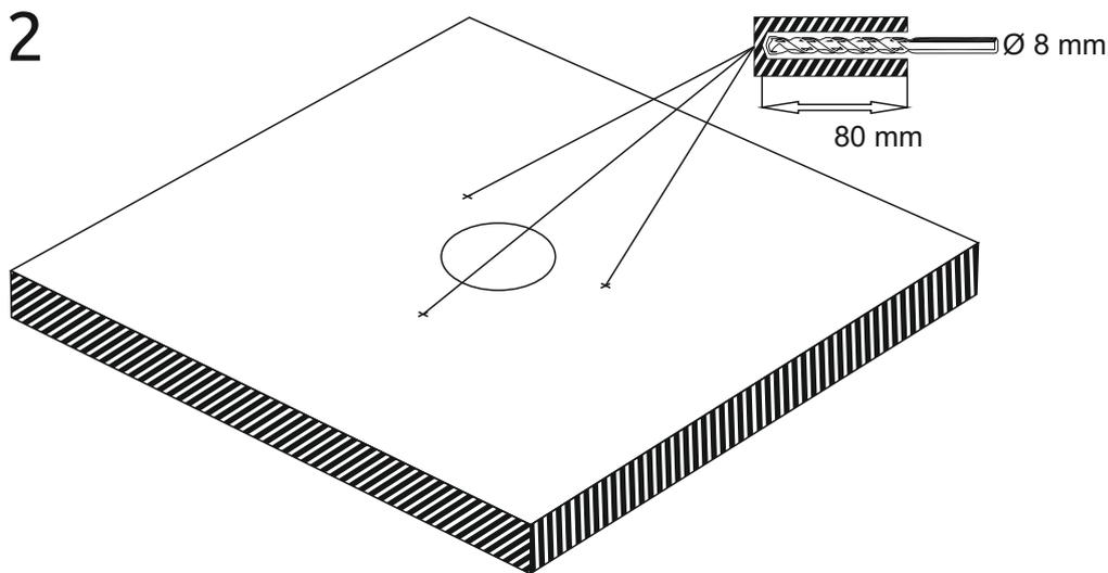
2. Po označení dajte stĺpik bokom a vyvŕtajte 3x otvory pre kotvy, vrtákom s priemerom 8mm do hĺbky 80 mm.
